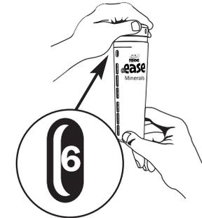
**Ajuste el FROG @ease Mineral Cartridge (azul)** en el n°. 6 (sostenga la parte inferior y gire la parte superior hasta que aparezca 6 en la ventana de ajuste). No es necesario realizar ajustes adicionales durante la vida útil de este cartucho.
