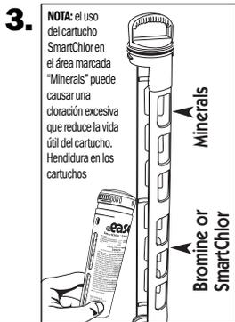
Enganche el FROG @ease Mineral Cartridge en el área marcada "Minerals" y el FROG @ease SmartChlor Cartridge en el área marcada "Bromine or SmartChlor", asegurándose de alinear la hendidura en la parte superior de los cartuchos con el área levantada del portacartuchos.
